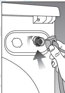
Для предотвращения протечки воды следует закрывать краны на тот период, когда машина не используется. Г-образный конец шланга подключается к входному штуцеру.
